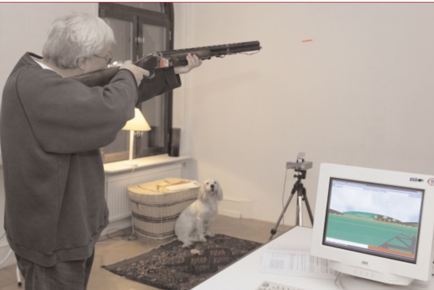
Med hjälp av DryFire på ett kamerastativ, din hagelbössa och en PC kan du träna hagelskytte hemma. På grund av kamerans långa exponeringstid syns den rörliga laserpunkten på väggen som ett streck. Efter skottet visar datorskärmen hagelsvärmen i förhållande till målet.
